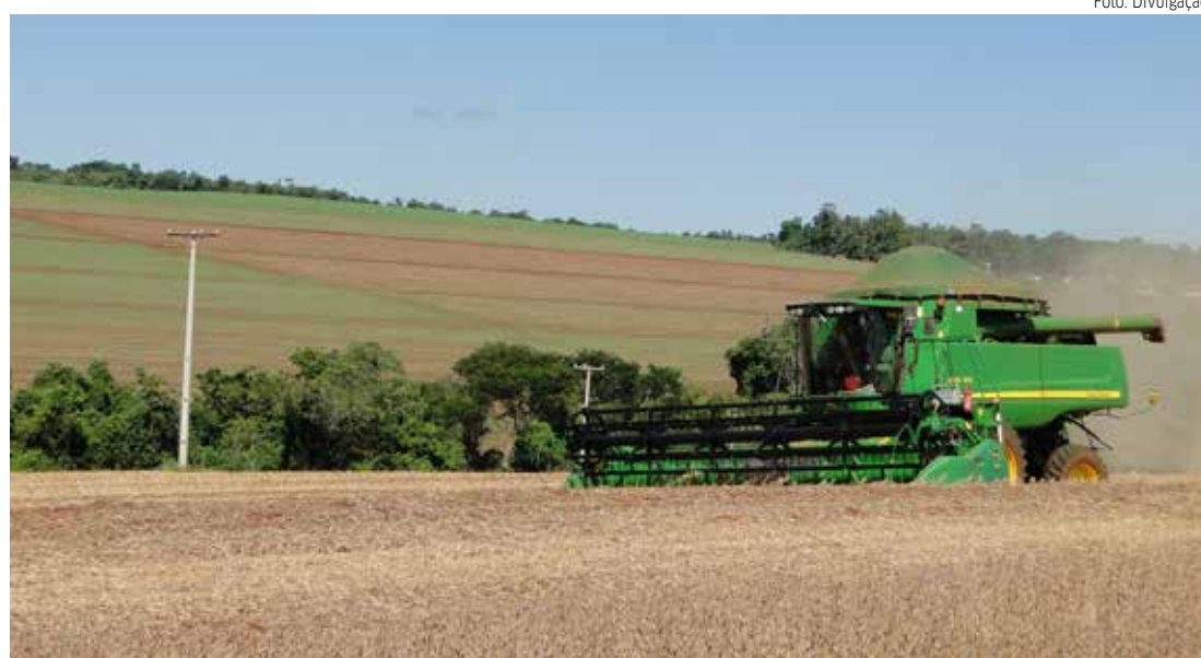
Operação de maquinário alto próximo à rede é uma das principais causas de acidentes por choque elétrico em áreas rurais
